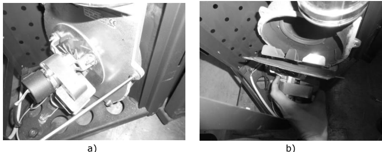
Figura 19 - a) Retirar os parafusos; b) Retirar extrator
