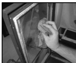
Figura 14 - Limpeza do vidro: a) aplicar líquido no pano; b) limpar o vidro com o pano
