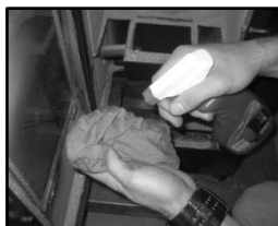
Figura 14 - Limpeza do vidro: a) aplicar líquido no pano; b) limpar o vidro com o pano
