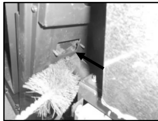
Figura 18 - a) Aspirar o interior; b) Limpeza com escovilhão
