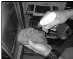
Figura 14 - Limpieza del vidrio: a) aplicar líquido al paño; b) Limpie el vidrio con el paño
