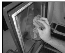
Figura 14 - Limpieza del vidrio: a) aplicar líquido al paño; b) Limpie el vidrio con el paño
