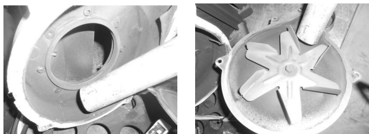
a) b) Figura 20 - a) Aspirar la carcasa extractora; b) Aspirar la bomba
