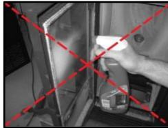
Figura 13 - Limpieza incorrecta del vidrio
