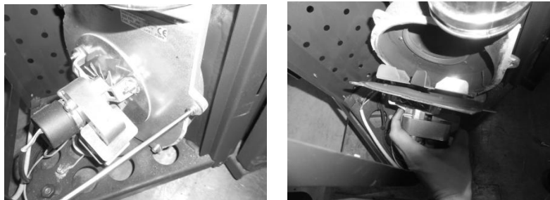
a) b) Figura 19 - a) Retire los tornillos; b) Retire el extractor
