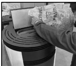
Figura 12 - Rellenar el depósito de pellets
