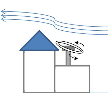
**Figura 20 - Altura incorrecta de la chimenea**
