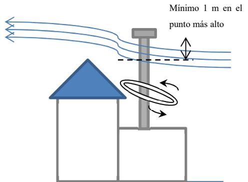
**Figura 21 - Altura correcta de la chimenea**
