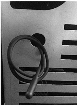
**Figura 24 - Sonda de temperatura ambiente**
