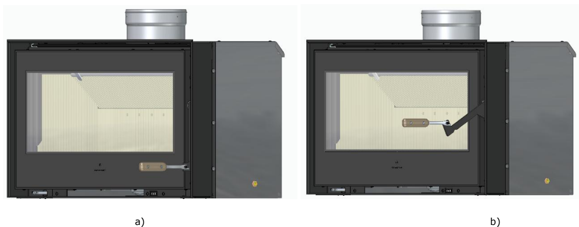
Figura 19 – a) Posición correcta de la llave, b) Movimiento de apertura de la puerta
