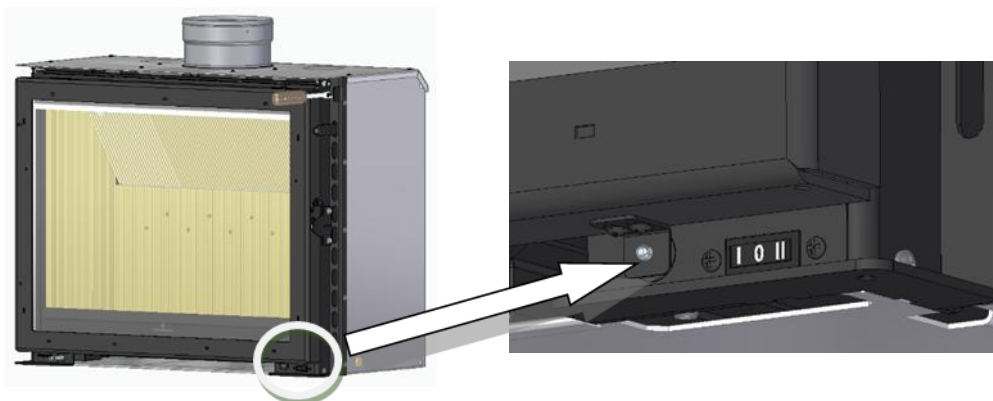
Figura 49 – Ajuste de la manilla de la puerta, funcionamiento del microinterruptor
