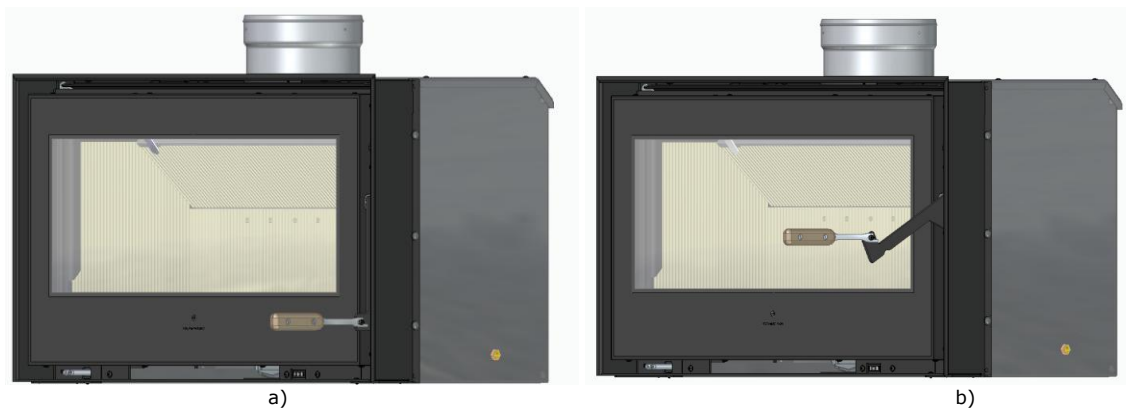
Figure 19 – a) Position correcte de la clé. ; b) Mouvement d'ouverture de la porte
