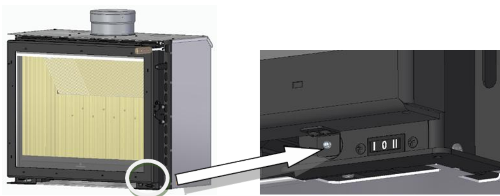
Figure 49 – Réglage de la poignée de porte, fonctionnement par micro-interrupteur
