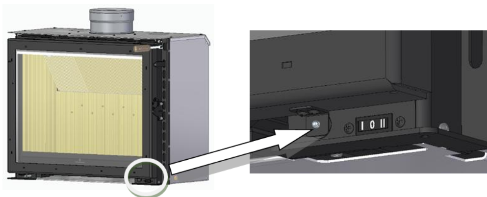
Figura 50 – Ajuste de la manilla de la puerta, funcionamiento del microinterruptor
