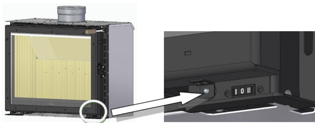
Figure 50 – Réglage de la poignée de porte, fonctionnement par micro-interrupteur
