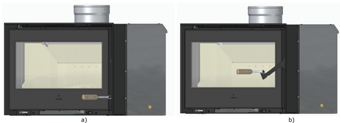
Figure 20 – a) Position correcte de la clé. ; b) Mouvement d'ouverture de la porte
