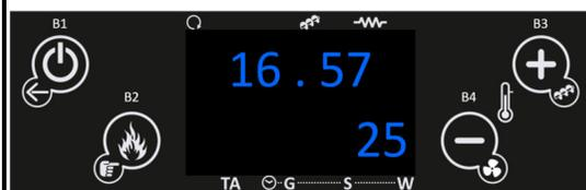
Accéder au menu de sélection de la puissance de combustion
